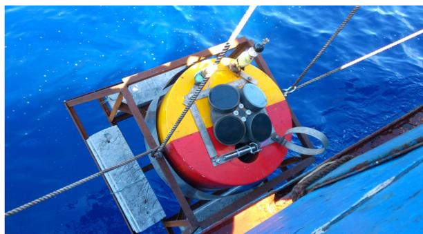
图 3 自升式连体潜标测量系统投放照片
