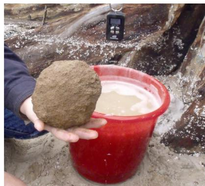
图 9 土样崩解后形成的球形体
