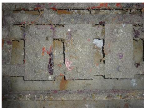
图3 浸海 3.5 年 TA<sub>2</sub> 板框架照片
