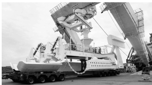
图4 与VPM开沟犁配套的回填犁
