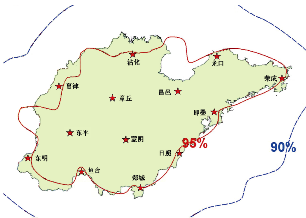
图 6 山东省 LD-II 闪电定位系统探测效率图
