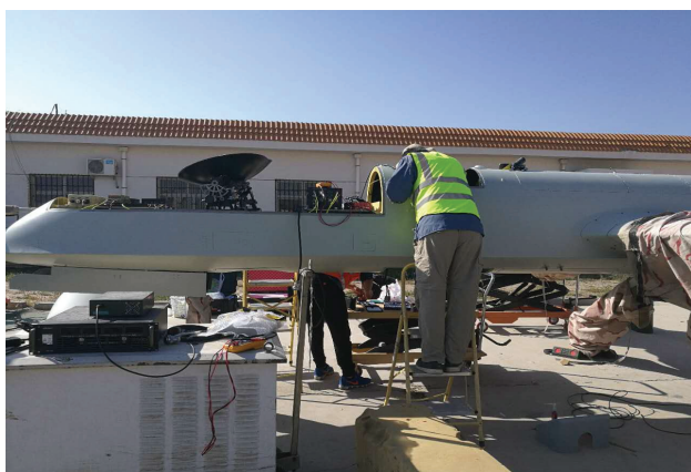
图 5 机载动中通天线安装实物图
