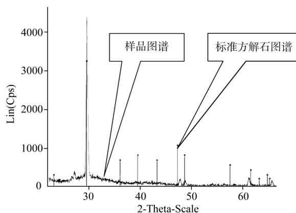
图 1 网纹藤壶壳板矿化结构的 XRD 图谱
