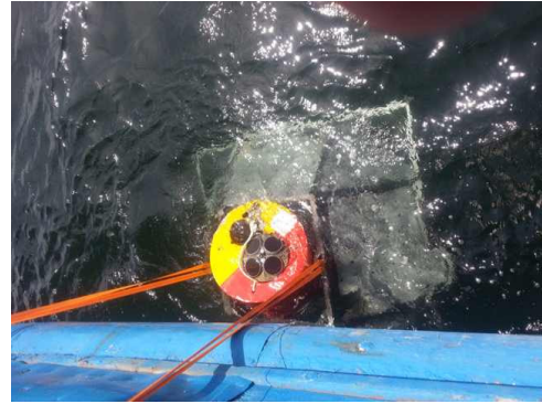
图 3 掩体式防拖潜标探测装置海上投放示意图
