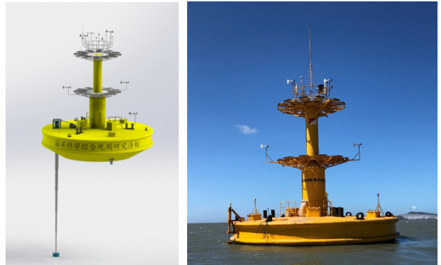
图2 基于大型浮标的自由伸缩式海洋剖面观测系统示意图和实际照片
