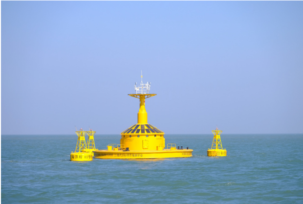
图1 三锚式浮标综合观测平台实际运行图
