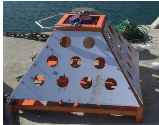
图 2 浅海小型坐底式海洋环境监测系统实物图
