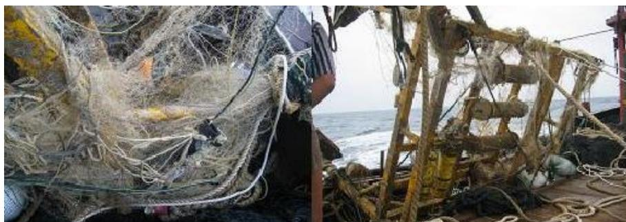
图4 南海布放的坐底式海洋环境监测系统被渔网缠绕情形
