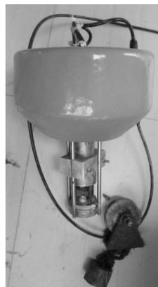
图 1 温度传感器浮子式安装图
