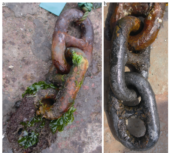
图 4 CM690 未镀锌锚链逐年腐蚀形貌对比 Fig. 4 Comparison of corrosion morphologies of the anchor chain without galvanized layer 注: a. 2013 年 7 月; b. 2014 年 7 月
