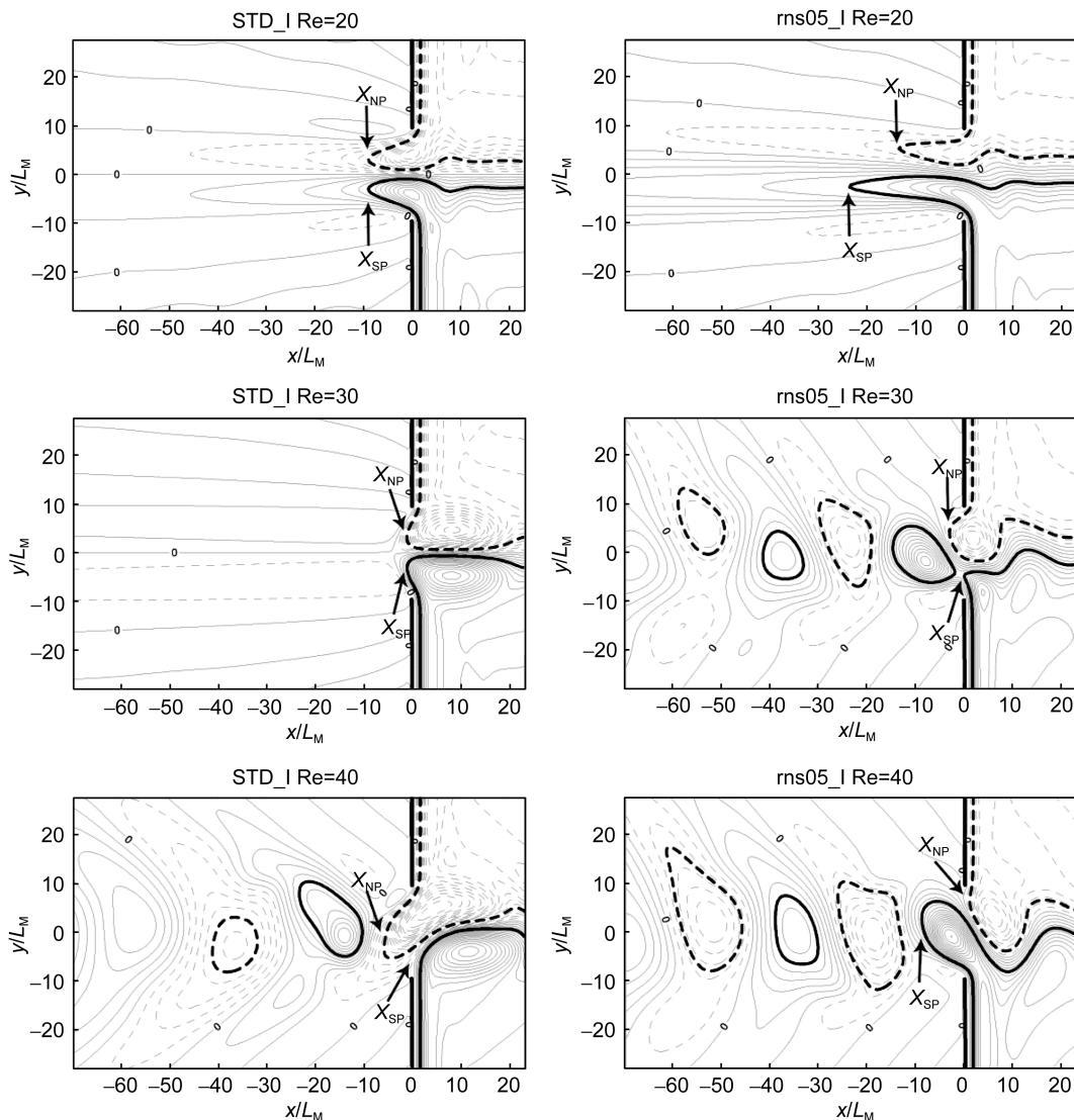
图4 理想地形实验中, 交汇的西边界流在缺口附近流态依赖雷诺数(Re)变化的情况(摘自 Wang et al, 2014)
