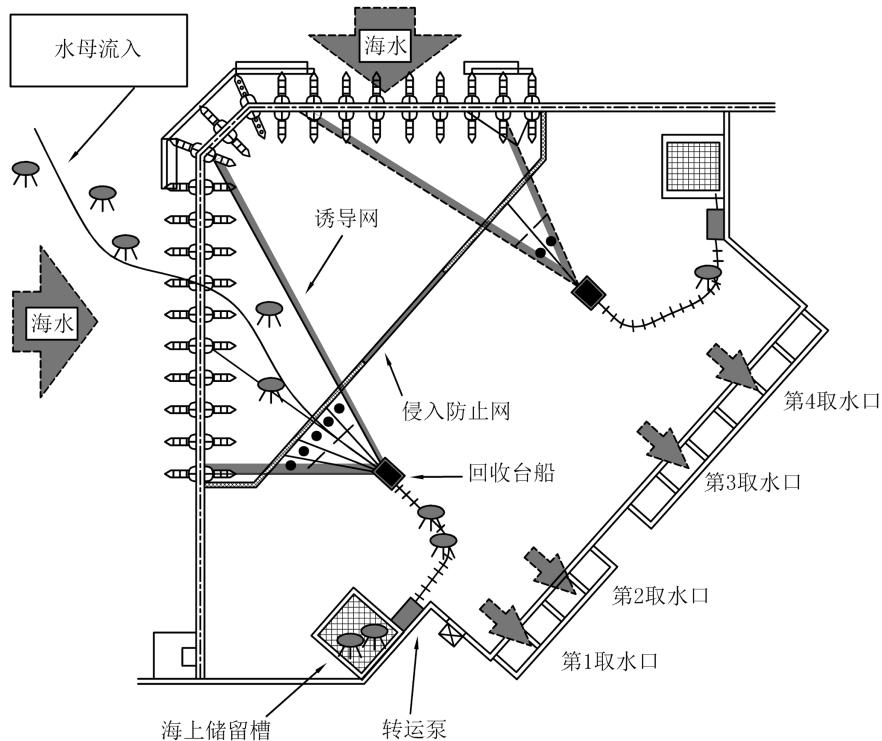
图 4 日本某发电厂水母海上处理系统示意图(引自片冈一成, 2014, 重新画图)
