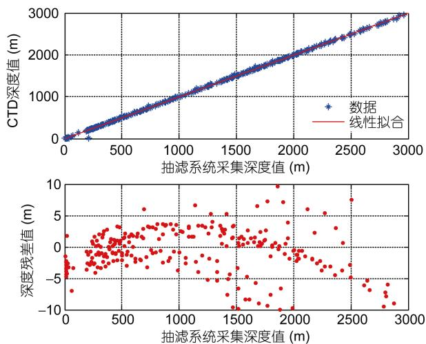
图 5 原位采样系统与 SeaBird 37-CTD 测量深度对比
