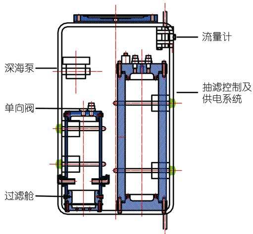
图 1 深海海水原位采样及分级过滤系统结构示意图
