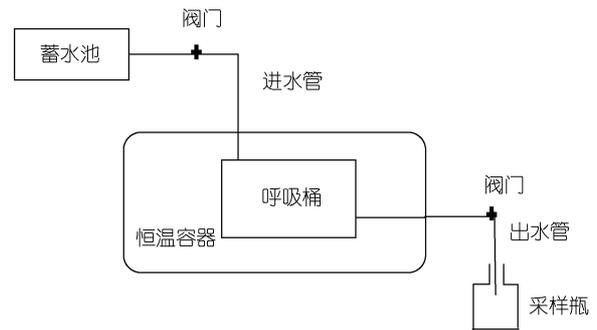
图 1 澳洲鳎窒息点测定试验装置
