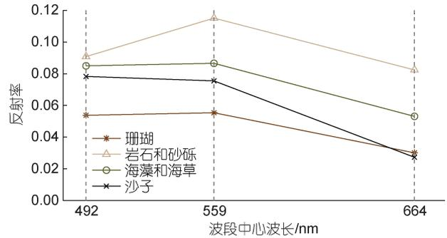
图 9 Sentinel-2 卫星大气校正后影像获得的 4 种底质的典型可见光波段光谱反射率
